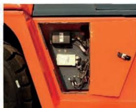
Compartimento separado para el sistema eléctrico
